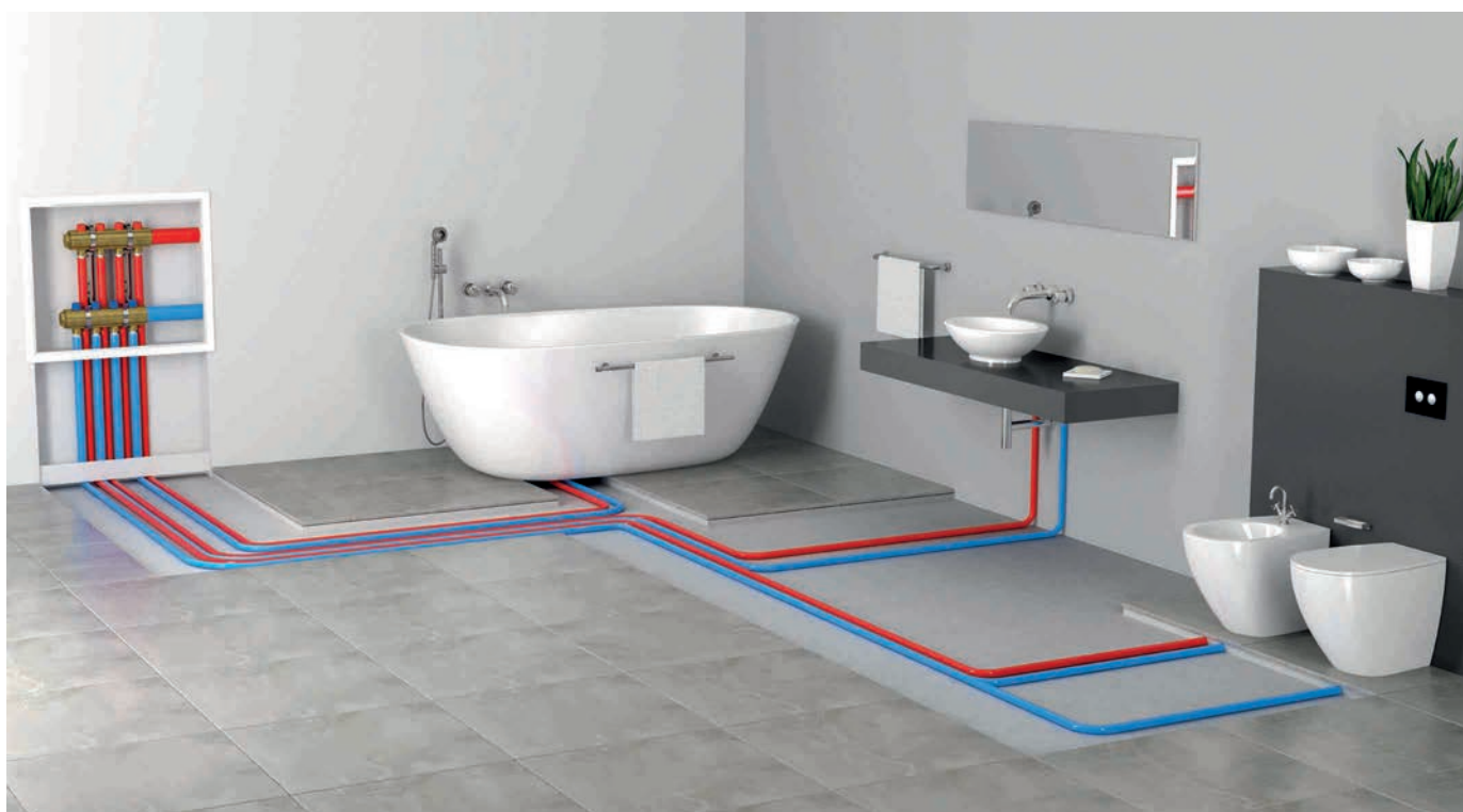
Sanitární zařízení realizované z vícevrstvých předizolovaných trubek nebo trubek s barevnou ochrannou ohebnou hadicí
